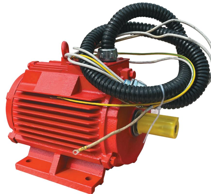
Электродвигатели асинхронные с короткозамкнутым ротором предназначены для работы в системах аварийного дымоудаления в течение не менее 2 часов при температуре среды 300-400 °С. Провода обмоток, изоляционные материалы, пропитка обмоток, выводные устройства электродвигателей и лакокрасочное покрытие – по DIN EN 12101 и DIN 18232.
