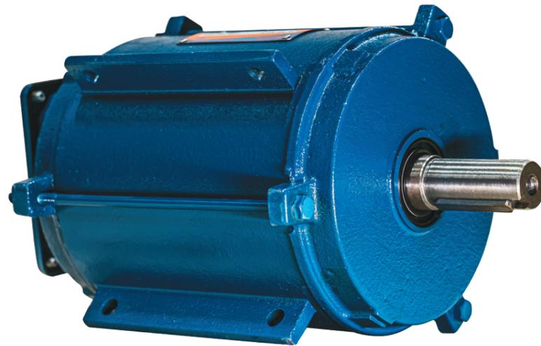
Электродвигатели серии 5АИП – трехфазные двигатели с короткозамкнутым ротором. Предназначены для привода вентиляторов, устанавливаемых в животноводческих и птицеводческих помещениях с искусственной вентиляцией. Электродвигатели рассчитаны на работу в воздушной среде с повышенным содержанием двуокиси серы, сероводорода, аммиака, хлороводорода. Устанавливаются в вытяжном камине вентиляционно-отопительной системы на растяжках с осевым вентилятором на конце вала.
