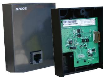
Модуль интерфейса RS485 для N700E 0,4-3,7 кВт
